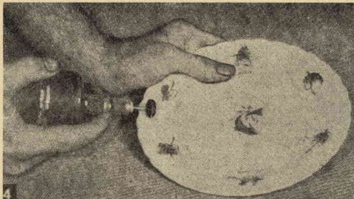
Una passatina leggera con lo smeriglio rende il giunto meno visibile, asportando il cemento spremuto fuori dal giunto
