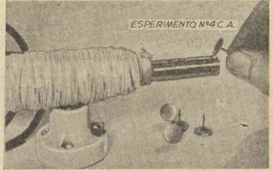
In una barra di acciaio magnetizzata per mezzo della corrente continua il magnetismo scompare per effetti delle continue inversioni di senso del campo prodotto da una corrente alternata.
